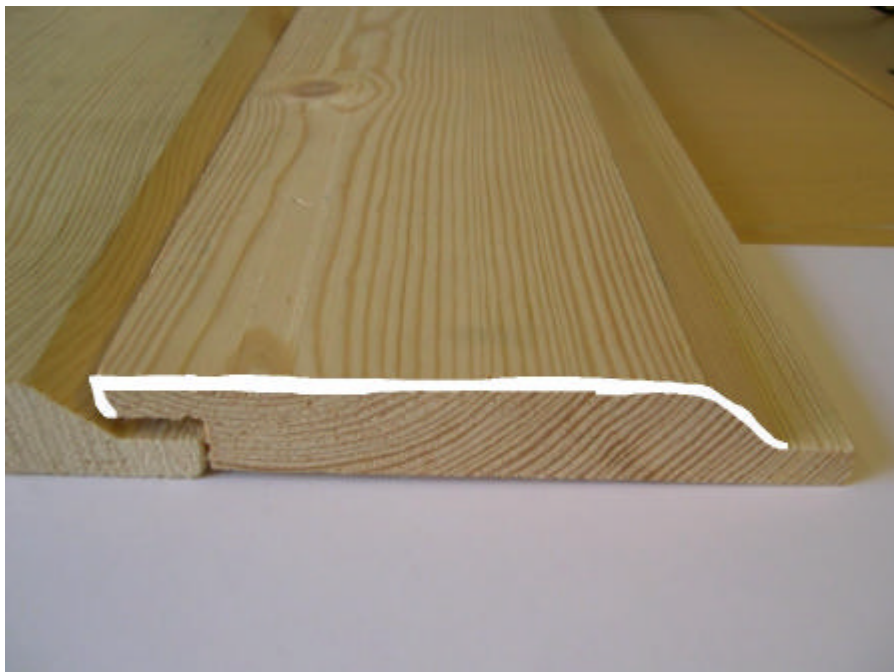
Bilde 2 Den hvite streken på bildet markerer den delen av utvendig overflate som var påført overflatebehandling. Det tilsvarer den delen av overflaten som normalt blir behandlet når overflatebehandlingen gjøres etter at bordene er montert på veggen.
